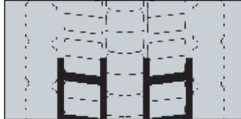
Profondeur de recreusage : 3 mm. Largeur de recreusage : 6-8 mm. Rechapable par Dunlop MultiTread
